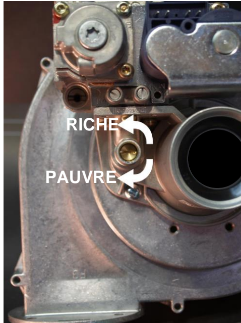
Illustration 2 - Vis de ratio du mélange air/gaz
